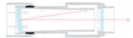
En los visores Aimpoint, la lente frontal del visor (doble lente) refleja hacia tu ojo la luz roja que emite el LED, dejando pasar limpiamente hacia tu ojo toda la luz que entra por delante. (© Aimpoint AB).
